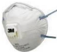
**Торговая марка, страна происхождения:** "3М" США/Великобритания **Защитные технические характеристики (заполняет поставщик):** Чашеобразный Фильтрующая полумаска с запатентованным клапаном выдоха 3М CoolFlow. Фильтрующая часть - нетканый материал из волокон полипропилена с электростатическим зарядом на волокнах (технология Advanced Electret). Две резинки крепления. Защита от аэрозолей (пыль, дымы металлов) до 12 ПДК. Цвет резинок - синий.
